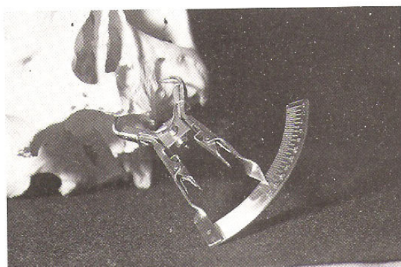
Fig. 9 — Inserzione-spessimetro applicato in zona canina-premolare superiore sinistra, su teschio.
