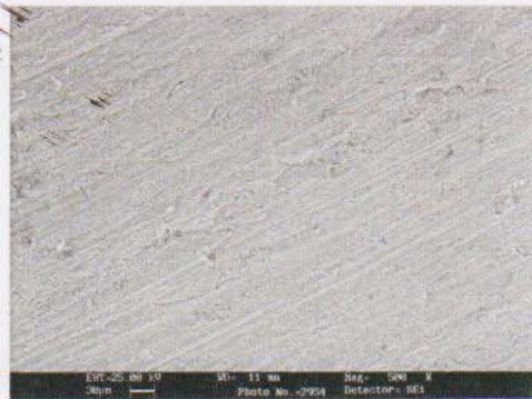
Fig. 5- Coupe au niveau du soudage électrique vue au microscope en grossissement x 500.
