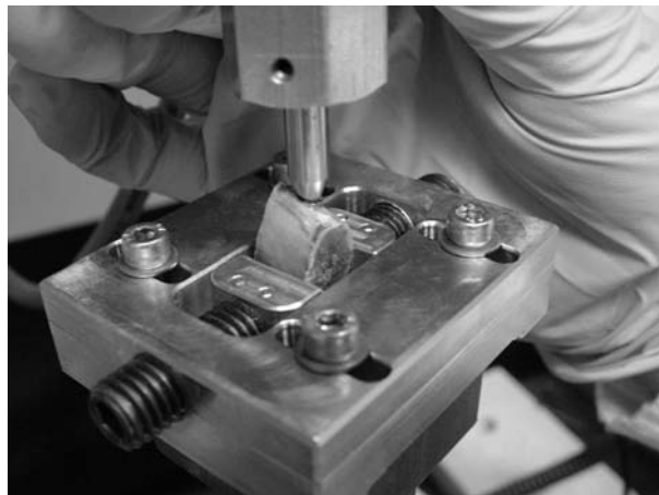
Figura 3. Campione bloccato nell'afferraggio con punzone per la prova meccanica
