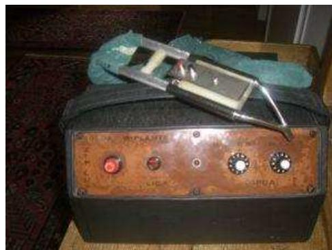
Figure 10-11: Primi modelli di saldatrice endorale
